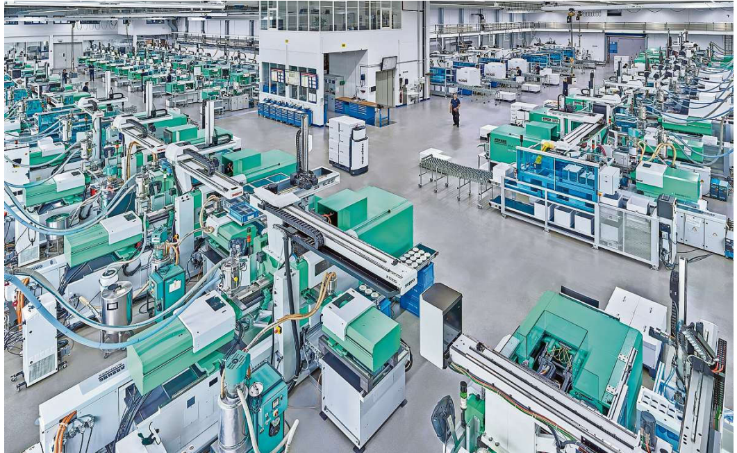
Vollautomatische Produktion: In der Halle mit den Spritzgussmaschinen sind viele Roboter am Werk.
